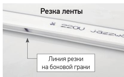
Во избежание повреждения ленты, разрезы производить не по линии разметки (знак «ножницы»), а по заводской технологической разметке, нанесенной на боковую грань светодиодной ленты «ГИБКИЙ НЕОН».
